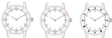
Fig. 7.2 Réglage du point de départ du chronomètre L'utilisateur part pour la gare routière à 10h10 et indique le point de départ du chronographe à l'aiguille des minutes.
