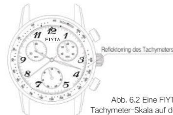
Abb. 6.1 Eine FIYTA-Uhr mit Tachymeter-Skala auf der Lünette
