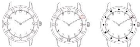
Abb. 7.2 Einstellen des Startpunkts am Chronographen Der Benutzer startet zur Bushaltestelle um 10:10 und richtet den Startpunkt des Chronographen am Minutenzeiger aus.
