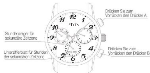
Abb. 5.1 Eine FIYTA-Uhr mit sekundärer Zeitzone, die mithilfe der Drücker eingestellt wird
