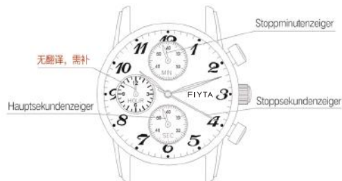
Abb. 3.2 Ein Armbandchronograph mit einer maximalen Zeitdauer des Chronographen von 11 Stunden 59 Minuten und 59 Sekunden
