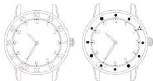
7.3 Ablesen der gestoppten Zeit am Chronographen Der Benutzer kommt an der Bushaltestelle um 10:35 Uhr an und der Minutenzeiger zeigt auf 25 oder die jeweilige Markierung.
